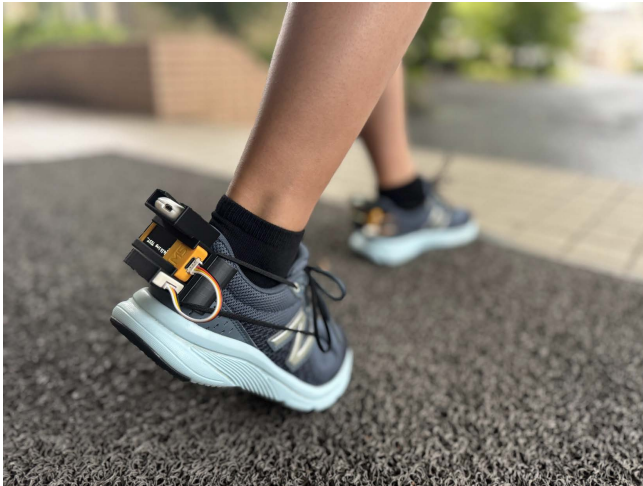
図 5: 靴装着型センサデバイスを装着した様子
